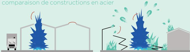
Une toiture et des panneaux bardage massifs avec des lanterneaux de décompression pour les explosions. Les bâtiments adjacents sont protégés.
