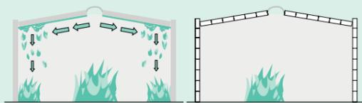
Autres matériaux de construction : Propagation de l'incendie et gouttes par les coulures de matières en fusion et incandescentes.
