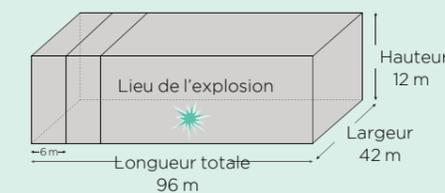
Dans un article spécialisé, l'institut de la technologie des constructions massives et des matériaux de construction de l'université de Karlsruhe a étudié les charges de rupture du béton cellulaire et de tôles profilées trapézoïdales. Pour pouvoir comparer les effets d'une explosion sur un bâtiment, l'institut a sélectionné du béton cellulaire et des tôles profilées trapézoïdales comme matériaux légers pour le revêtement du bâtiment.
