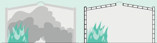
Autres matériaux de construction : Emissions fréquentes de fumées épaisses.
